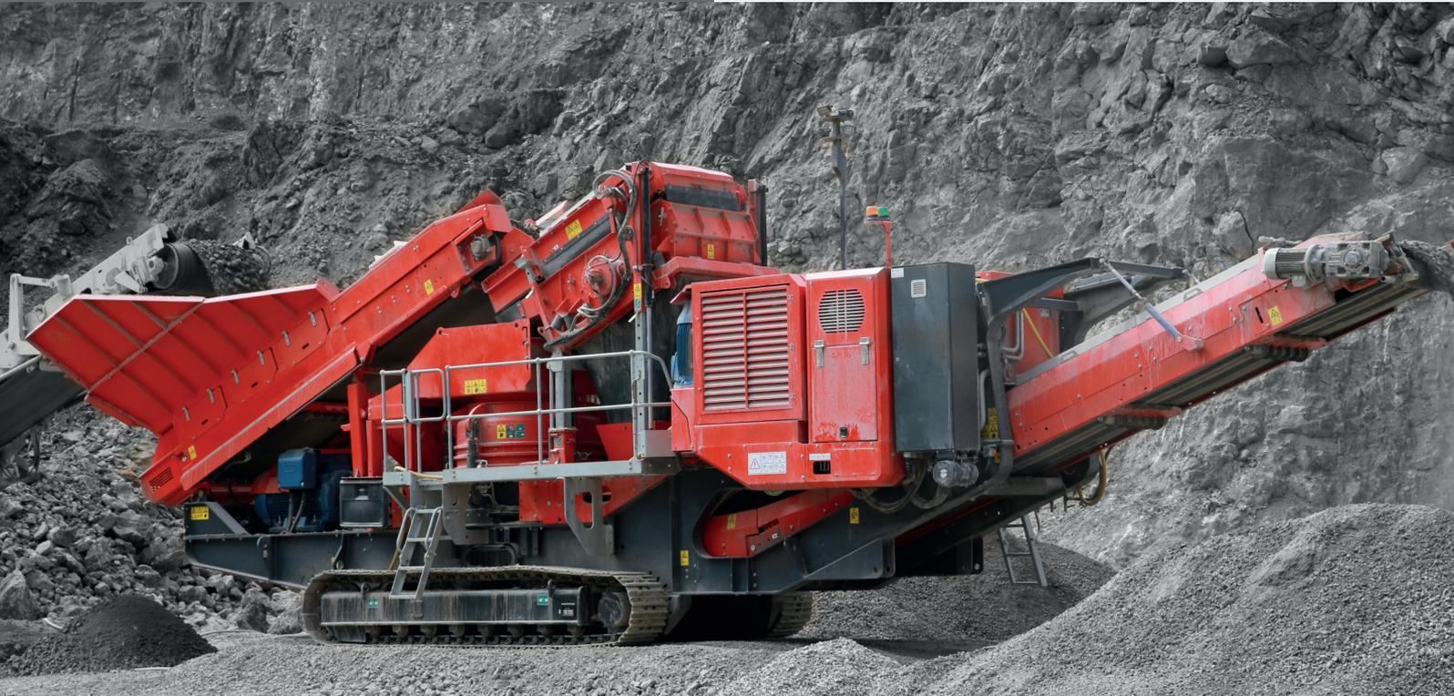
La trituradora de cono de doble Finlay® C-1540 ofrece a los operadores la flexibilidad de alimentar la planta mediante una conexión de la red eléctrica o mediante una unidad de grupo electrógeno incorporada. Cualquiera de las dos opciones de alimentación proporciona a los operadores una potencia significativa y ahorros en los costos de mantenimiento.
