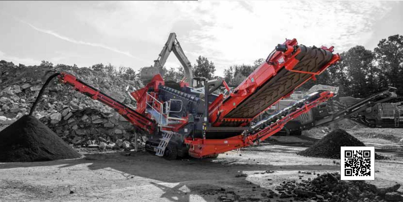
La Finlay® 883+ Spaleck es lo último en cribado móvil y tecnología de separación. El núcleo de esta máquina es una caja de cribado de 2 pisos de alto rendimiento, con construcción y diseño alemán. El diseño exclusivo del techo superior combinado con la mejor tecnología Flip Flow en el piso inferior convierten a la 883+ Spaleck en la mejor de su clase.
