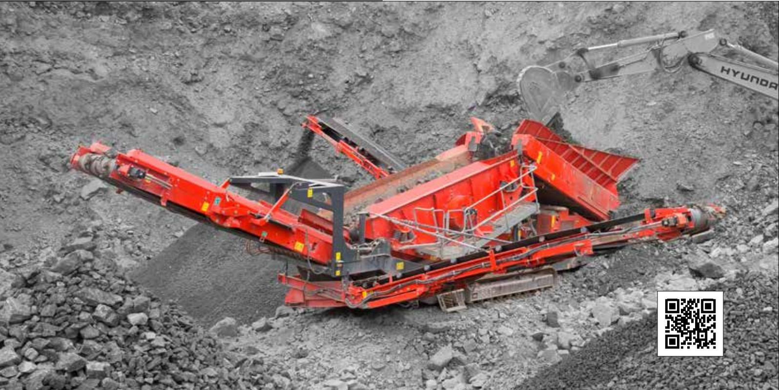
La cuarta generación de Finlay® 883+ se ha desarrollado como un precribador de servicio pesado, versátil y de alta capacidad destinado a utilidades de cribado primarias y secundarias como canteras y minería, mineral de hierro, escombros de demolición, arena, grava, compost, tierra vegetal y carbón.
