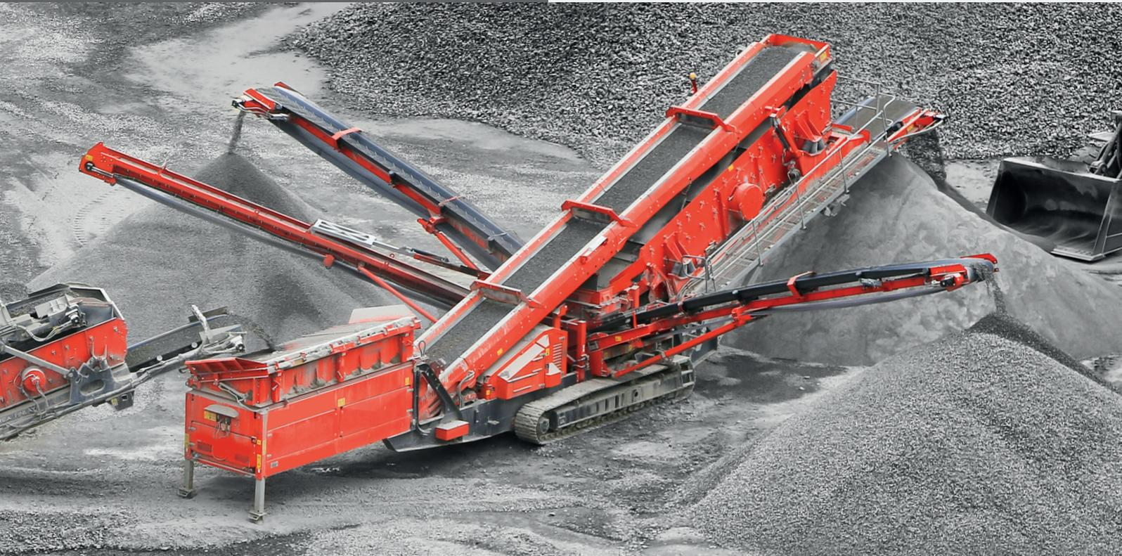
La criba inclinada Terex Finlay 696 de 3 pisos ha sido diseñada para proporcionar una solución avanzada de alta producción en aplicaciones de canteras, minería, arena y grava, carbón, astillas de madera y tierra vegetal. La nueva caja de cribado de alta energía es la más grande de la gama de tres pisos y cuenta con tres pisos de tamaño completo de 6,1 x 1,7 m (20' x 5'7"), lo que supone una superficie total de cribado de 31,1 m<sup>2</sup> (335 ft<sup>2</sup>).
