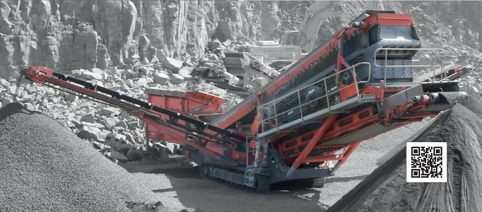
La Finlay® 693+ Spaleck es lo más novedoso en cribado móvil y tecnología de separación. En el corazón de la planta, hay una criba de 2 pisos de alto rendimiento y diseño alemán con la tecnología de vanguardia Flip Flow tanto en el piso superior como en el inferior.
