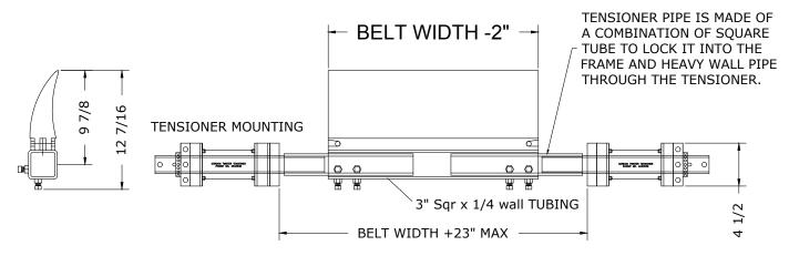
NOTE: IF LONGER SPAN IS REQUIRED, A LONGER MAINFRAME WILL BE REQUIRED. (CONSULT FACTORY FOR DETAILS)
